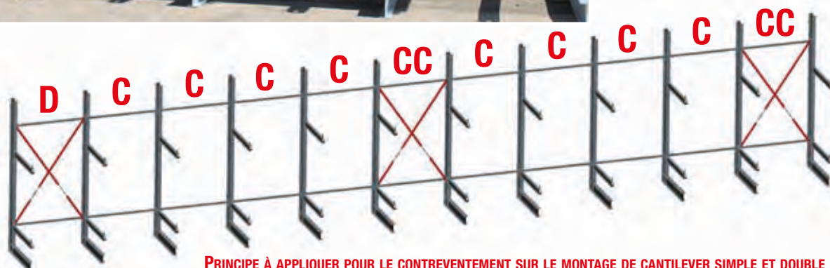
PRINCIPE À APPLIQUER POUR LE CONTREVENTEMENT SUR LE MONTAGE DE CANTILEVER SIMPLE ET DOUBLE
